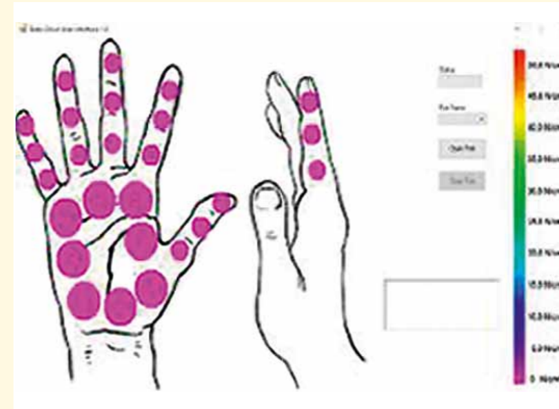
3 Structure schématique des positions de capteurs de pression dans le gant "intelligent".
